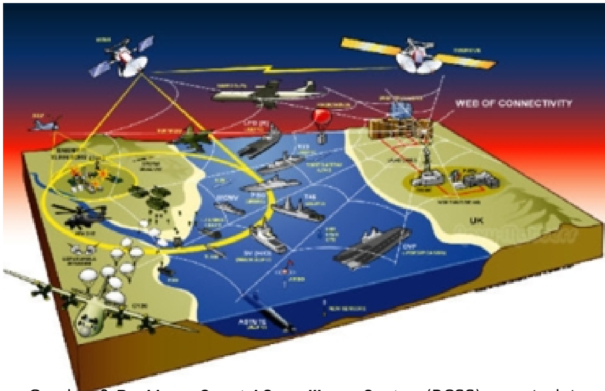
Gambar 9 Backbone Coastal Surveillance System (BCSS) yang terintegrasi dengan Bakamla Integrated Information System (BIIS)
