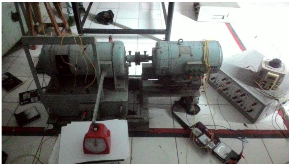
Gambar A.3 Motor arus searah yang digunakan untuk percobaan pembebanan
