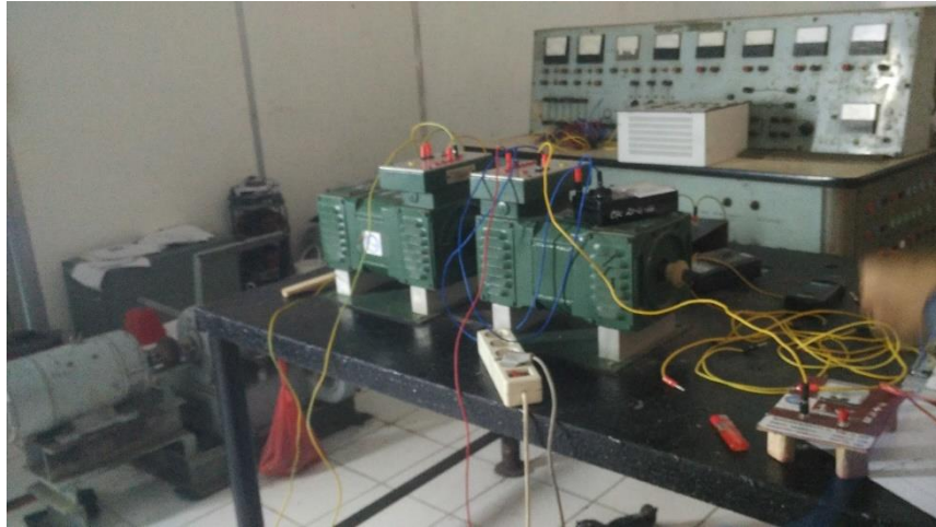
Gambar A.1 Motor arus searah yang digunakan untuk percobaan pengaturan kecepatan dan pengaturan tegangan
