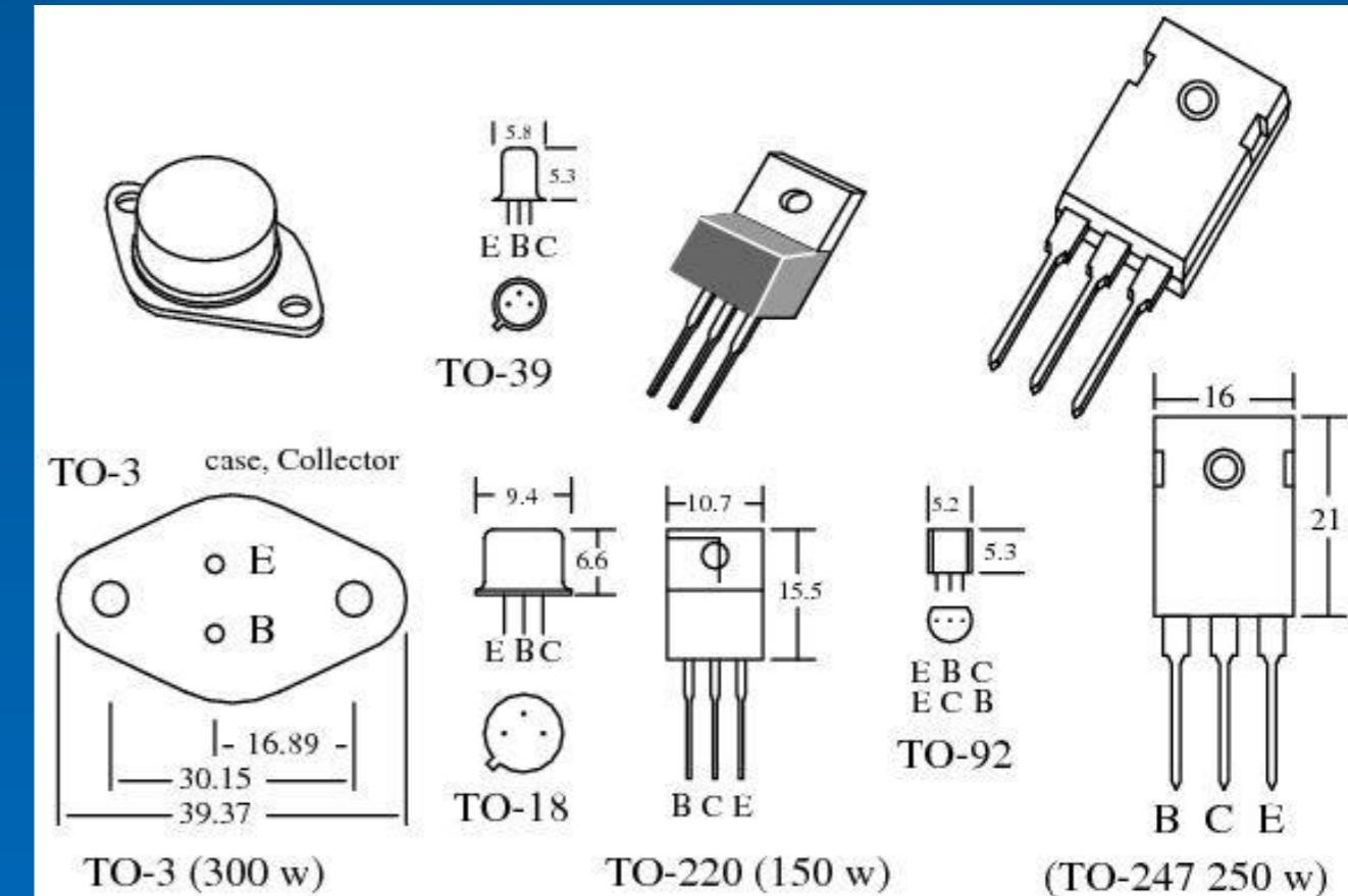
KAPASITAS DAYA     $[V_{ce} * |I_c|]$  maximum
