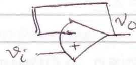
Catatan: umpan balik pada non-inverting input akan mengakibatkan OP-AMP jenuh/saturasi  $\rightarrow V_0 = +V_{cc}$  atau  $-V_{cc}$
