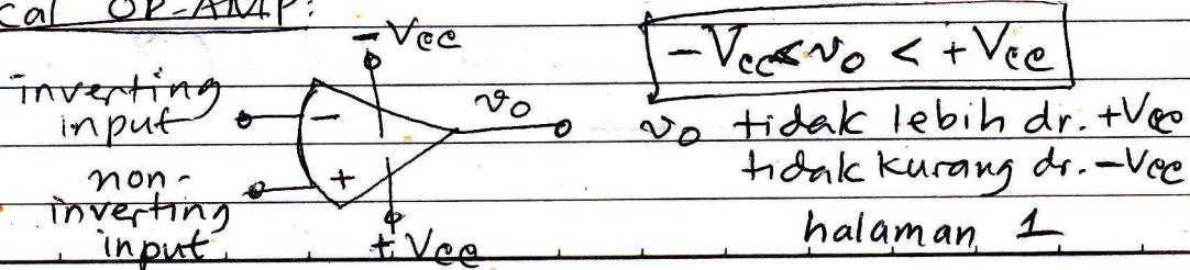
$$-V_{cc} \leq v_o \leq +V_{cc}$$
