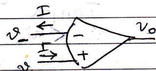
Arus  $I = 0$  (tidak ada aliran arus ke luar-masuk terminal  $v_+$  dan  $v_-$ )
