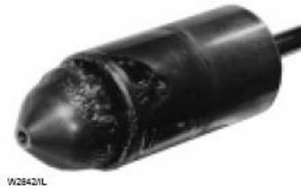
Gambar 4.53. Kerusakan yang diakibatkan Flashing
