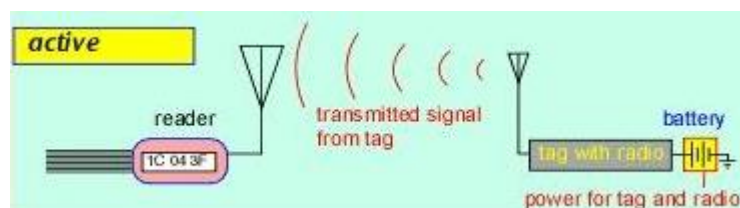
Gambar 4 Cara kerja RFID tag aktif
