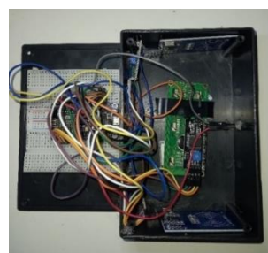
Gambar 3 Proses Perakitan Alat Penghitung Penumpang Bus Otomatis
