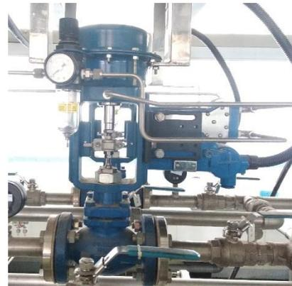
Gambar 6. Global Type Valve dengan I/P Positioner
