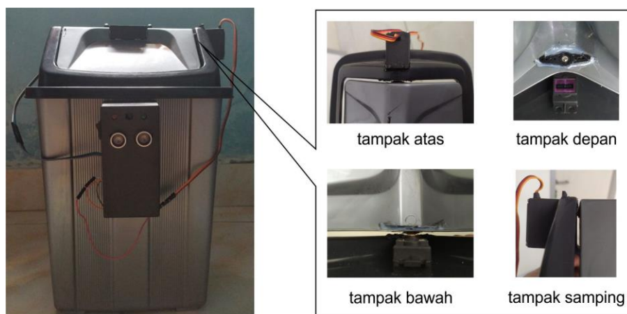
Gambar 3. 6 Kopel Motor dengan Tutup Tempat Sampah
