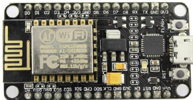
Gambar 2. 2 NodeMCU ESP8266
