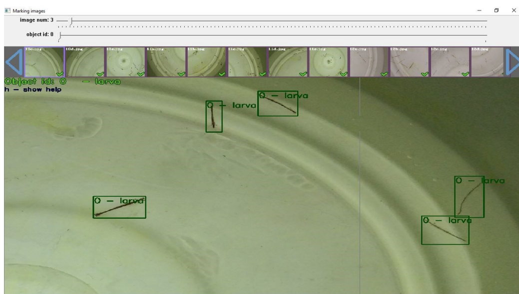
Gambar 23. Pelabelan menggunakan yolo_mark
