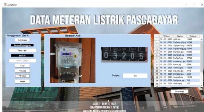
Gambar 11. Tampilan GUI dari Proses OCR
