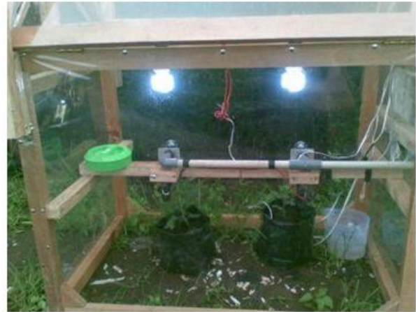
Gambar 9. Output sistem pada kondisi intensitas cahaya < set point
