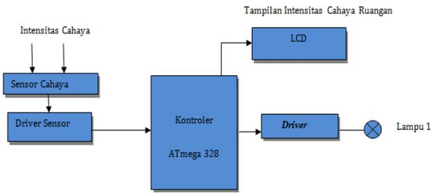
Gambar 3. Blok diagram sistem kendali intensitas cahaya
