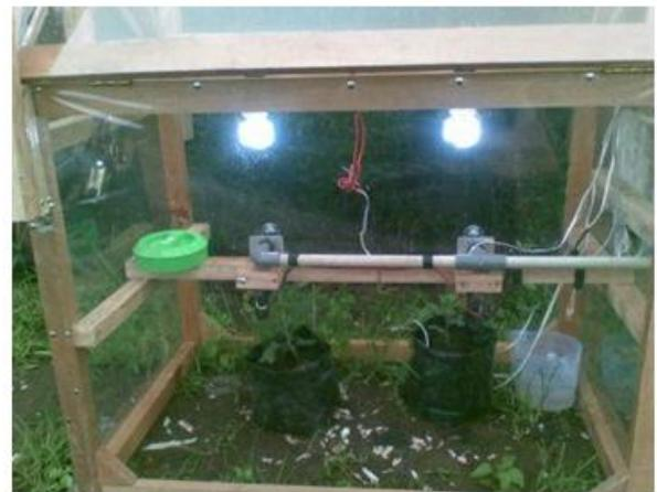
Gambar 8. Output sistem pada kondisi intensitas cahaya < set point
