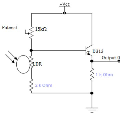
Gambar 4. Sensor LDR pada saat output logika 0
