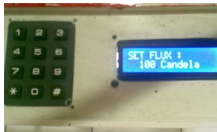
Gambar 4.9. Contoh pengaturan set point 100 lux
