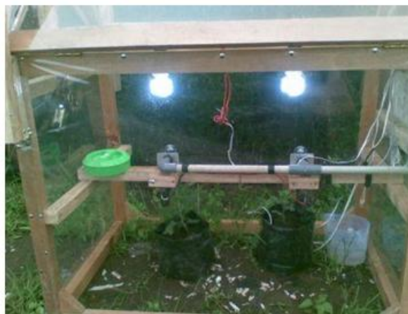
Gambar 4.10. Output sistem pada kondisi intensitas cahaya < set point
