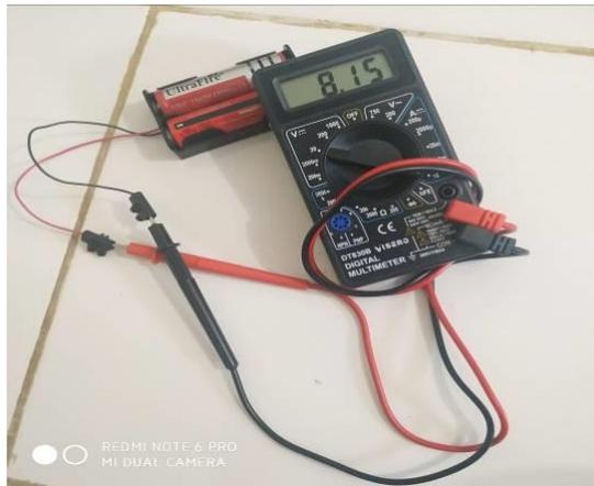
**Gambar 4.7** Pengujian Tegangan Pada Baterai Sebagai *Power Supply*
