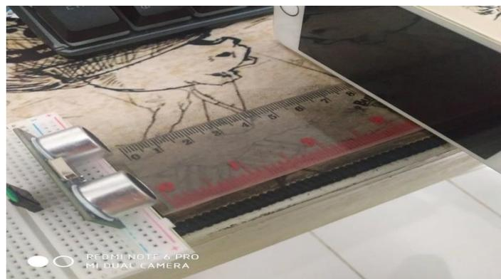
**Gambar 4.2** Pengujian Sensor dengan Objek dan Penggaris
